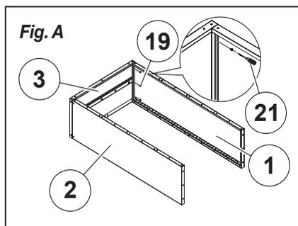
**Remarque :** Assurez-vous que l'avant du châssis de l'armoire est orienté vers le bas. Une fois le châssis de l'armoire monté, tournez le châssis de l'armoire en position droite pour fixer les panneaux arrières.
