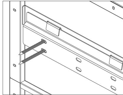
Vue en gros plan de la façon dont les supports muraux au mur s'adaptent avec les 6 crochets plats à l'arrière de l'armoire.
