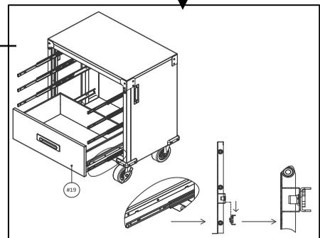
**Remarque :** Veuillez retirer les protecteurs en caoutchouc du crochet avant d'assembler les tiroirs sur la glissière.
