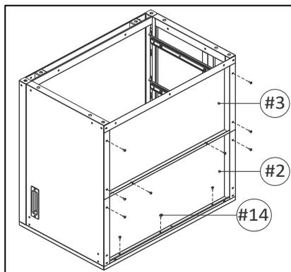
**2)** Fixez le panneau inférieur arrière (3) entre le panneau gauche (4) et le panneau droit (5). Assurez-vous que le haut du panneau inférieur arrière (3) est fixé au panneau supérieur arrière (2) comme l'indique l'autocollant. Alignez les trous de vis et utilisez les vis A (14) pour serrer le panneau arrière inférieur (3) au panneau arrière supérieur (2), au panneau gauche (4) et au panneau droit (5).
