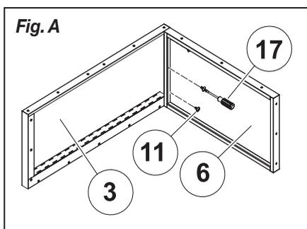
**2.** Placez le panneau de gauche (2) contre; le côté gauche du panneaux supérieur (6). Alignez les trous de vis des deux panneaux. Insérez trois vis M4 x 8 (11) dans les trous de vis et serrez-les avec le tournevis (17) (voir Fig. B).
