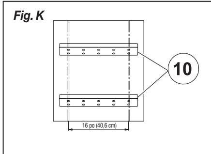
**3.** Insérez les chevilles dans les trous percés dans le mur. Ensuite, fixez les supports muraux (10) au mur à l'aide de quatre vis M6 x 60 (13) pour chaque support mural. Accrochez l'armoire aux supports muraux (voir Fig. L).
