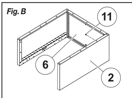
**3.** Fixez le panneau inférieur (1) aux panneaux de gauche (2) et droite (3). Alignez les trous de vis de tous les panneaux. Insérez trois vis M4 x 8 (11) dans les trous de vis de chaque côté du panneau inférieur et serrez-les avec le tournevis (17). Le châssis de l'armoire est monté (voir Fig. C).
